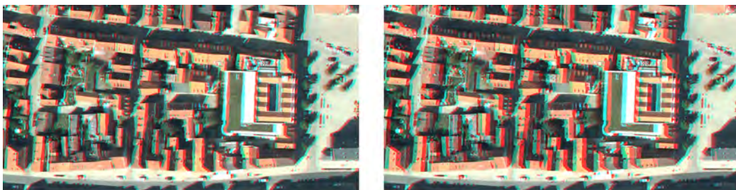
Abbildung 6.18: Anaglyphenbilder mit unterschiedlichen Oberflächenmodellen: Links = Laserscanning, Rechts = Bildkorrelation
