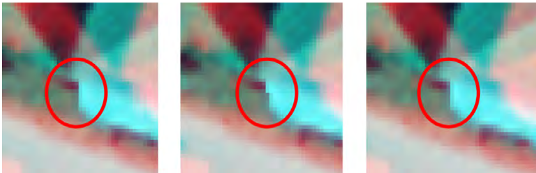
Abbildung 6.10: Pixelverschiebung beim Output Scale: Links = 1:2500, Mitte = 1:50000, Rechts = 1:100000
