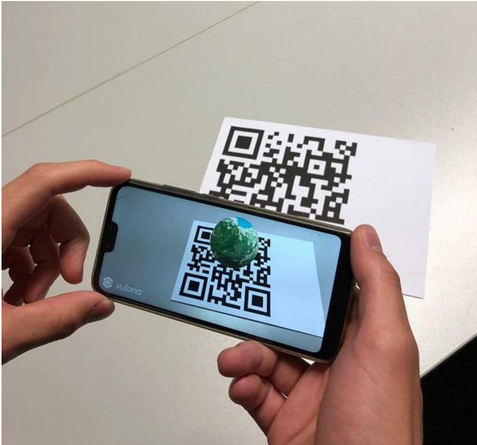
Abbildung 4: Beispielhafte Video See-Through-AR-Anwendung durch merkmalsbasiertes Tracking
