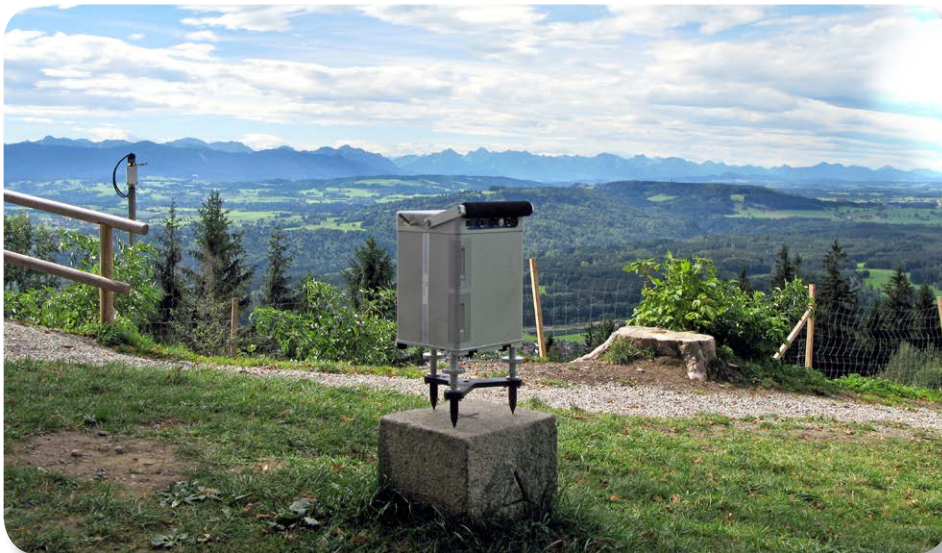
Gravimeter im Einsatz
